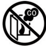
ストーブ扉 開放危険
